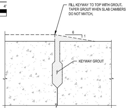
**S9** TYP. KEYWAY GROUT DETAIL
